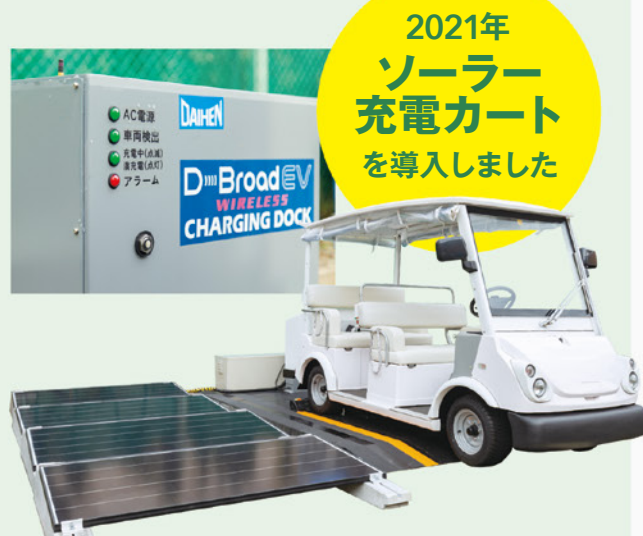
屋外駐車場に設置した太陽光発電パネルから電力を供給するソーラー充電カート。スムーズな業務に一役買っています
